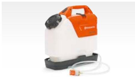
Kompakter und einfach zu handhabender Wassertank mit elektrischer Pumpe. Der Tank hat ein Fassungsvermögen von 15 Litern und erlaubt kontinuierliche Trennschneidarbeiten bis zu 45 Minuten. Akkubetrieb, 18,5 V Li-Ionen, Akkumulatorsystem.
