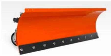
Robustes Stahl-Schneeräumschild mit hydraulischer Winkelverstellung und einer Arbeitsbreite von 135 cm. Erfordert Hydraulik-Bausatz und Gegengewichte. Um den Anforderungen der unterschiedlichen Gegebenheiten gerecht zu werden, muss das Schneeräumschild entweder mit Gleitkufen und Stahlleiste oder mit Stützrädern und Gummileiste kombiniert werden.
