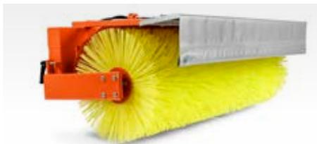
Zapfwellenbetriebene Kkehrbürste zum gründlichen Entfernen von dünnen Schneedecken, Laub und Schmutz. Verstärkte Version mit größerem Durchmesser und erweiterter Winklereinstellung. Max./Min. Arbeitsbreite 130 cm. Erfordert Hydrauliksat und Heckgewicht.
