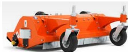
Zapfwellenbetriebener Schlegelmäher. Überarbeitete Bauform mit verstärktem Kegelgetriebe, erweitertem Schritthöhensbereich und verbesserter Leistung bei dichter Vegetation. Die schwenkbaren Front-Laufräder sind pannensicher. Arbeitsbreite 120 cm. Nur für den Einsatz mit dem P525/520 D empfohlen. Erfordert Heckgewicht.
