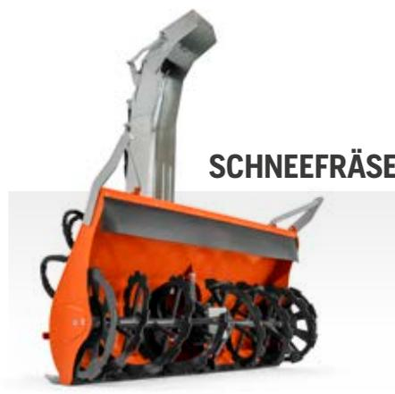
Hocheffiziente zweistufige Hochleistungs-Schneefräse. Erfordert Hydrauliksatz und Gegengewicht. Arbeitsbreite 120 cm. Auswurfrotation 300 Grad.
